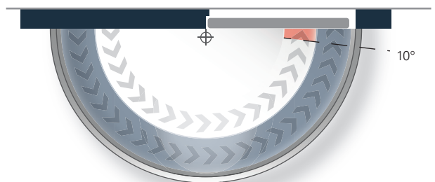
Schließkraftdiagramm ECO Newton TS-15 B, Bandseite
