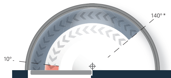
Schließkraftdiagramm ECO Newton TS-15 B, Bandgegenseite
